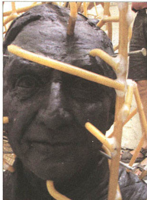
Das Wachmodell mit den orangefarbenen Gusskanälen, durch die die flüssige Bronze geleitet wird.
